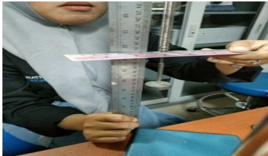
Gambar 1. Ilustrasi Pengukuran Panjang Pegas dan Posisi Mata untuk Menghindari Kesalahan Paralaks
