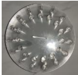
Gambar 1. Phantom akrilik dengan lubang yang diisi kepingan aluminium
