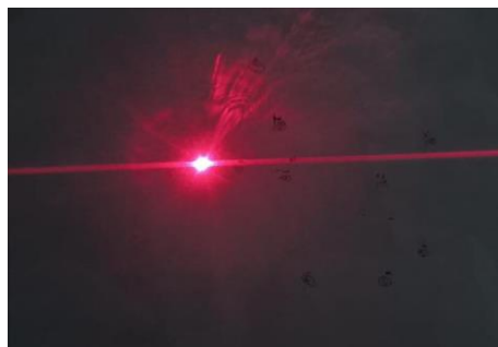
Gambar 7. Pola Interferensi Cahaya pada Kisi Jarum
