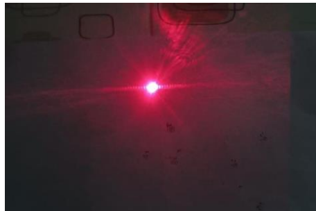
Gambar 6. Pola Interferensi Cahaya pada Kisi Benang
