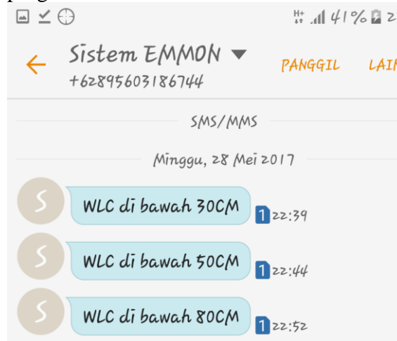
Gambar 4. Sistem mengirim SMS ketika terjadi (Level air kurang dari set point)
