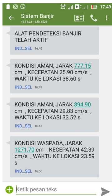
Gambar 17 Pengujian modul GSM SIM 800L kondisi aman
