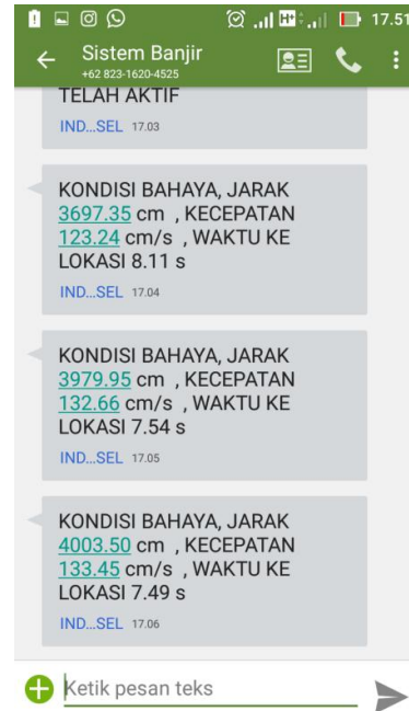
Gambar 19 Pengujian modul GSM SIM 800L kondisi bahaya
