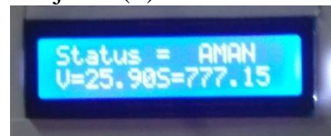
Gambar 14 Tampilan LCD kondisi aman
