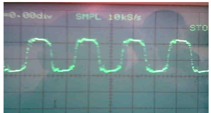
Gambar 16 Sinyal output IC 555
