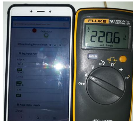
Gambar 1 Pengujian sensor tegangan ZMPT101B
