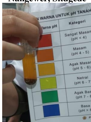
Gambar 2. Hasil uji pH Tanah menggunakan PUTK
