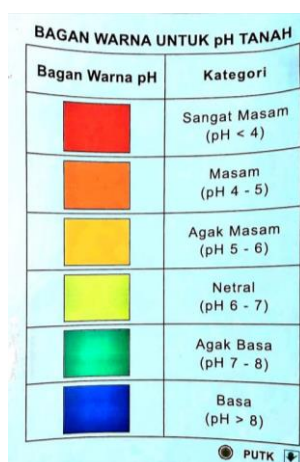
Gambar 1. Bagan warna untuk pH tanah pada PUTK
