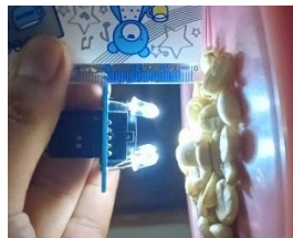
Gambar 6. Pengujian jarak pada sensor TCS3200 dengan biji Kopi.
