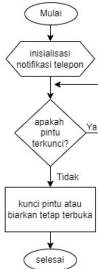
Gambar 5. Flowchart kontrol kunci pintu dengan SMS.
