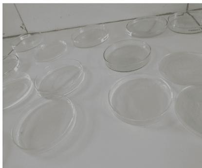
**Gambar 2.** Proses pencetakan lapisan *film* pada cawan petri
