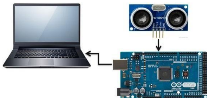
Gambar 2. Koneksi pengujian jarak oleh sensor ultrasonik melalui serial monitor pada komputer/laptop.
